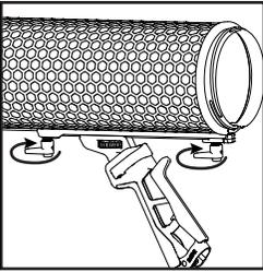
2. Allentate la leva di fissaggio anteriore e quella posteriore del binario (di circa 1~2 giri).
