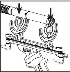
4. Posizionate il microfono sopra le clip Lyre e premetelo dolcemente all'interno delle clip Lyre, verificando che il microfono si trovi nella giusta posizione.
