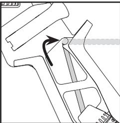
4. Fermate il cavo con il gancio di fissaggio del cavo che si trova in alto nella maniglia.
