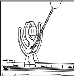
3. Dopo esservi assicurati che la clip Lyre sia centrata e in posizione corretta nel binario, stringete di nuovo la vite di fissaggio.
